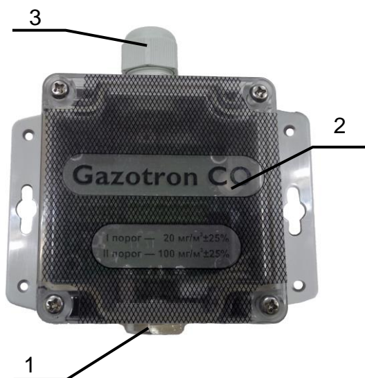
1 – датчик; 2 светодиод; 3 – гермоввод
